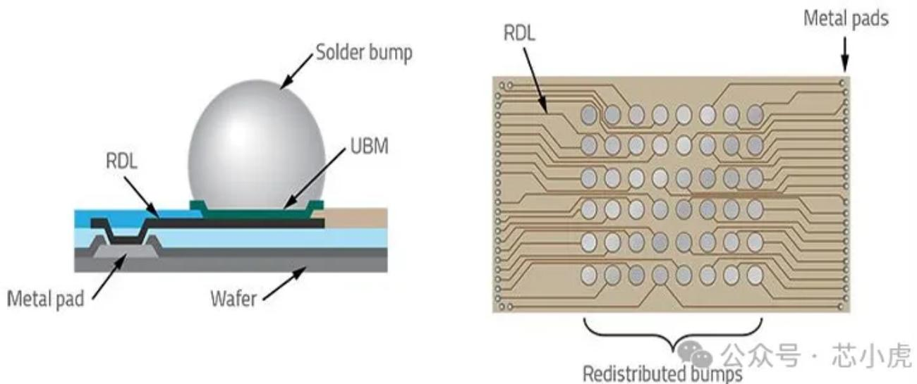
RDL (Re-distributed layer) 作为实现芯片水平方向电气延伸和互连的关键技术，在 3D/2.5D 封装集成以及 FOWLP (扇出型晶圆级封装) 中发挥着举足轻重的作用。它通过在芯片表面沉积金属层和相应的介电层，巧妙地形成金属导线，并将 IO 端口重新设计到更宽敞的区域，构建出表面阵列布局。这一创新技术不仅使得芯片间的键合更薄，简化了工艺，还让设计人员能够以更为紧凑和高效的方式放置芯片，从而显著减少了器件的整体占地面积。
